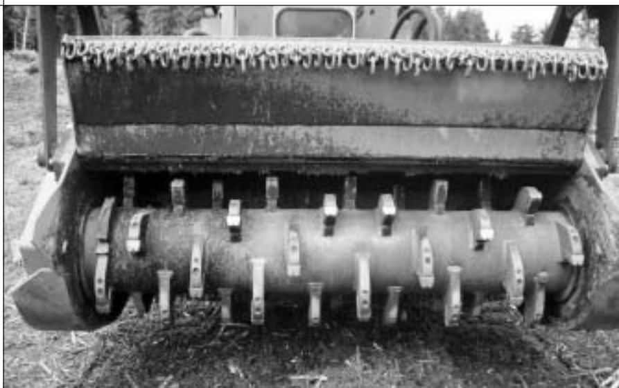
Broyeur forestier lourd à marteaux fixes pour la réalisation de l'andainage
