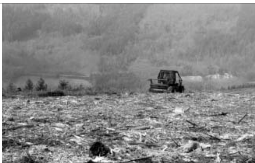
Le broyage en plein s'est effectué avec un broyeur lourd à marteaux fixes ou un broyeur plus léger à marteaux mobiles.
