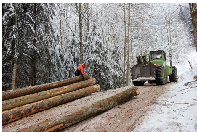
Photo 3 : Le débardage au skidder à câble reste très majoritaire dans les Alpes.
