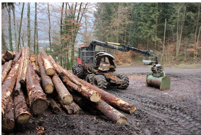
Photo 4 : porteur équipé d'un klemmbank pour la reprise des bois sur une piste non accessible aux camions
