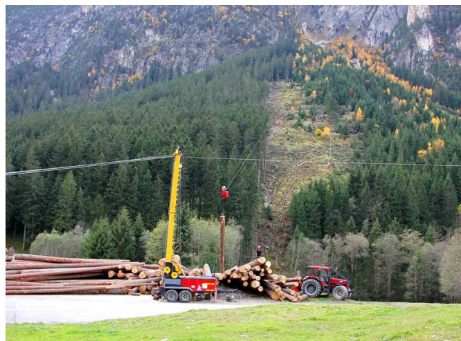
Photo 5 : Une équipe de deux personnes suffit à faire fonctionner un câble mâât et une 3 ème personne est associée à l'équipe pour le bûcheronnage
