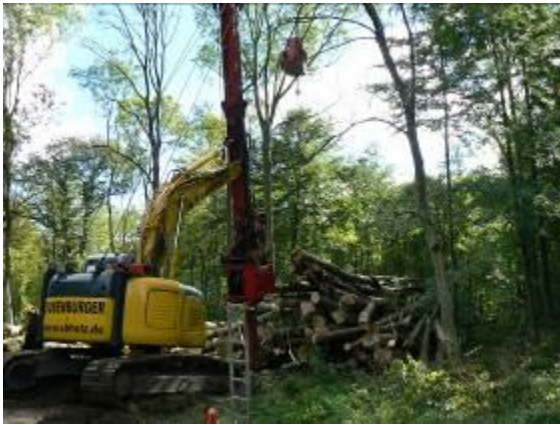
Photo 9 : Câble-mât pliant Grizzly 400 de Konrad à monter sur pelle hydraulique, câble porteur de 400 m
