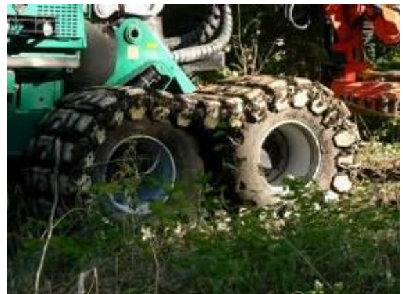
Photo 3 : Tracks Felasto Pur, modèle Raup F, avec patins en polyuréthane
