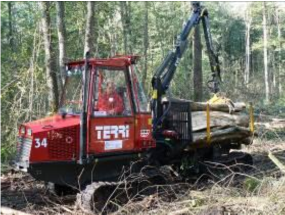
Photo 1 : Terri 34 Pression au sol en charge 0,460 kg/cm 2 , Capacité de chargement 3,6 T
