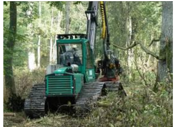
Photo 11 : Prosilva 910, 155 kW, avec train amovible de chenilles de 80 cm de large amovible
