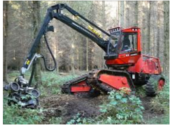
Photo 10 : Komatsu 911.5 X3M, 170 kW, 24,2 T pour une pression au sol de 0,504 kg/cm 2 avec des chenilles synthétiques de 60 cm de large
