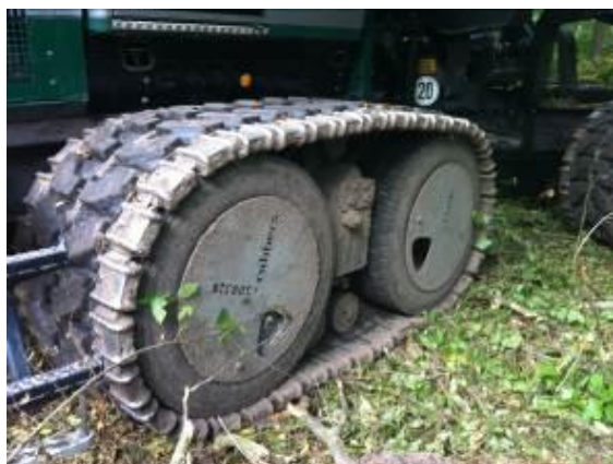
Photo 5 : Galets entre les roues (de la société FHS) sur le système Quattro
