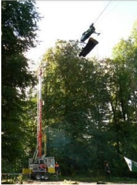
Photo 8 : Câble-mât Adler MS401 pour du bois court porté, câble porteur de 400 m
