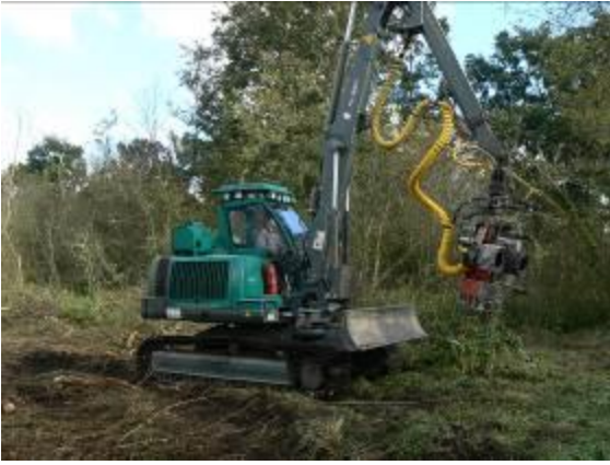
Photo 12 : 9002 HV, 74 kW, la plus petite des pelles de la gamme Neuson Ecotec pour les 1 ères et 2 èmes éclaircies avec des chenilles de 50 à 70 cm de large
