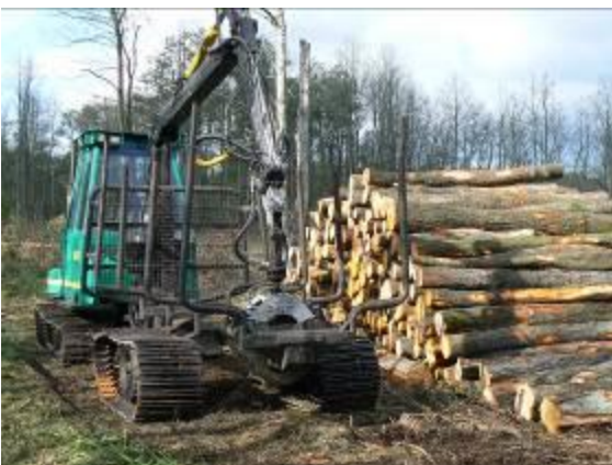
Photo 2 : Logbear F4000 Pression au sol en charge 0,460 kg/cm 2 Capacité de chargement 4,5 T
