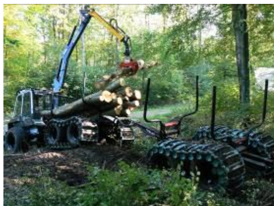
Photo 7 : Malwa 560F Capacité de chargement 2 x 4,5 T
