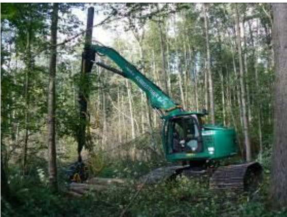
Photo 13 : Impex Königstiger T25 Moor, 126 kW pour les gros bois chenilles de 1,30 m de large, grue de 16 m
