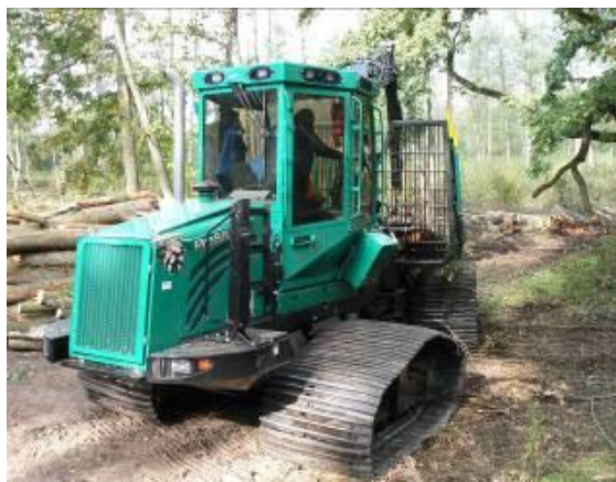
Photo 6 : Porteur Prosilva F15-4ST 15 T de charge, 4 trains chenillés
