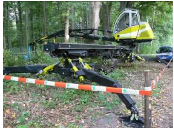
Photo 15 : Prototype Portalharvester Rail de 10 m qui se plie et se déplie Surface circulée sur la parcelle : objectif 1% !
