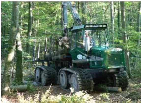
Photo 4 : Porteur FHS 81/10 de 10 T de charge équipé du système Quattro de Street Rubbers
