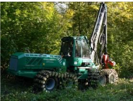
Photo 14 : Tracks synthétiques Felasto Pur sur une machine de bûcheronnage Gremo 1050, 164 kW
