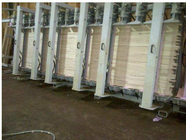
Figure 4: Production des poutres en lamellé-collé (Source : CCSP)
