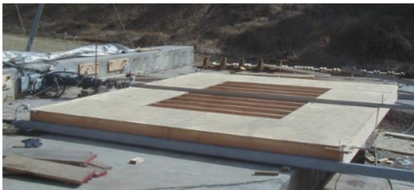
Figure 6 : Plancher de 5 x 6 m avec ouverture centrale
