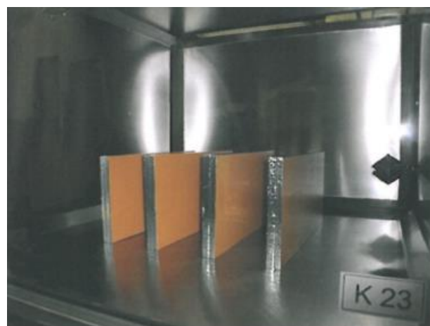
Photo 6 : Méthode d'essai selon ISO 16000
