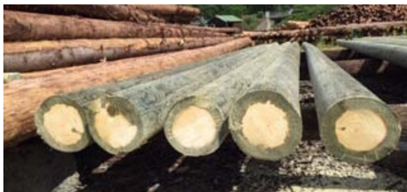
▲ Poteaux support de ligne en Epicéa, traités sous certification CTB-B+ pour un usage classe d'emploi 4
